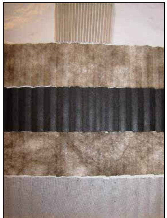
Filtret består af flere lag. I dette filter ses 5 lag. De 2 yderste er trådnet og de 3 inderste filtdug.
